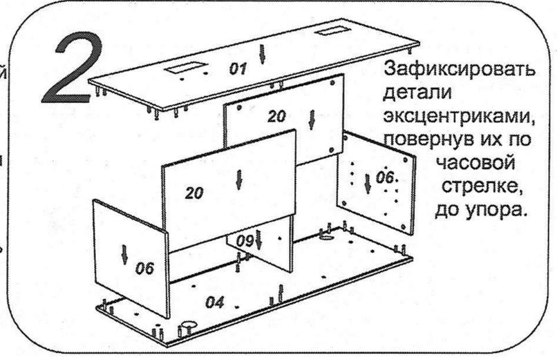
Зафиксировать детали эксцентриками, повернув их по часовой стрелке, до упора.
